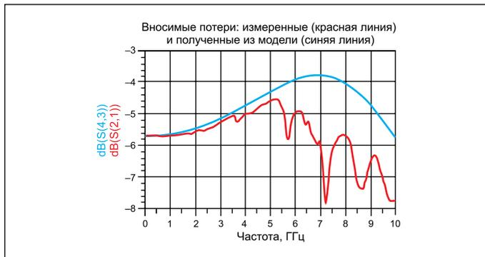
Рис. 9. График s-параметров, сравнивающий измеренные s-параметры с полученными из модели
