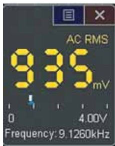
Рис. 23. Окно показаний встроенного вольтметра-частотомера
