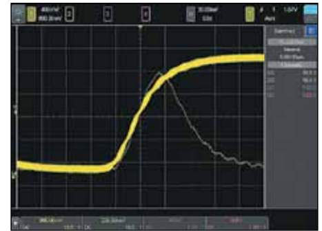
Рис. 8. Выделение аномалии (глитча) с помощью персистенции
