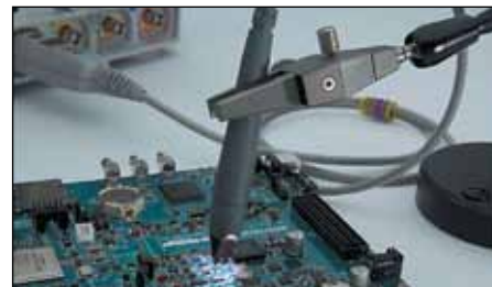
Рис. 3. Подключение осциллографа к тестируемой печатной плате через пробник с зажимом FreeHand
