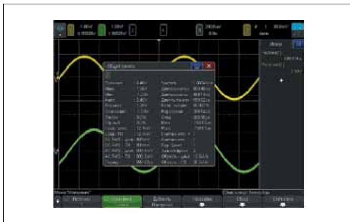
Рис. 17. Осциллограммы синусоидального сигнала и панель со списком всех автоматических измерений
