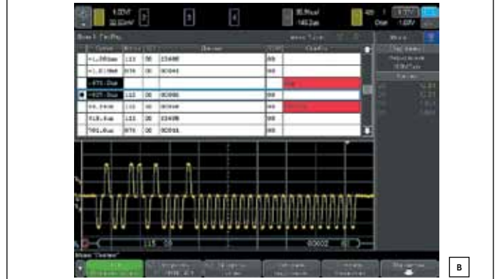
Рис. 21. Анализ последовательной шины данных: а) по протоколу I 2 C; б) по протоколу SPI; в) по протоколу ARINC 429 с двухполярным сигналом данных
