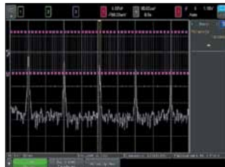
Рис. 18. Осциллограмма меандра и его спектра, вычисленного с помощью БПФ
