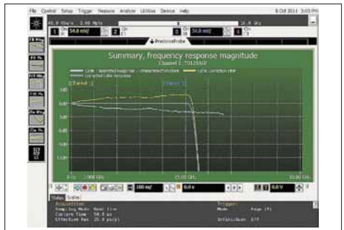
Рис. 19. Экран осциллографа с АЧХ пробника
